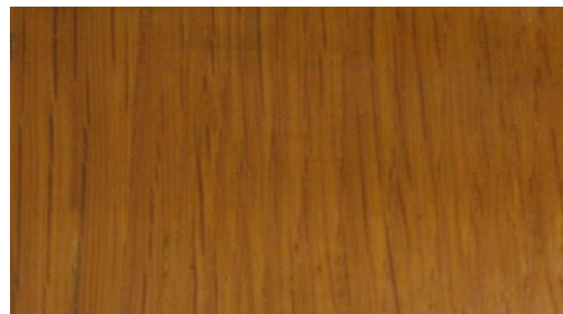
Chêne avec le système de glacis recommandé ci-dessus, avec rebouchage des pores, après 3 années d'exposition aux intempéries
