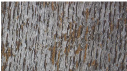
Chêne avec un système de glacis standard, sans rebouchage, après 3 années d'exposition aux intempéries
