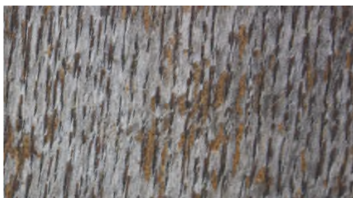
Eichenholz mit Standard Lasuraufbau, ohne Spachtelung, nach 3 Jahren Bewitterung
