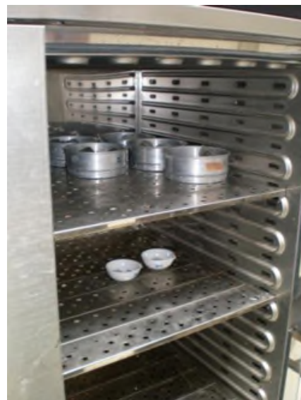
Séchage des échantillons dans une étuve climatique
