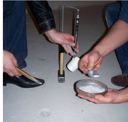
Obtention d'un échantillon de chape pour la méthode CM
