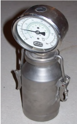
Flacon d'échantillonnage avec manomètre utilisé pour la méthode CM
