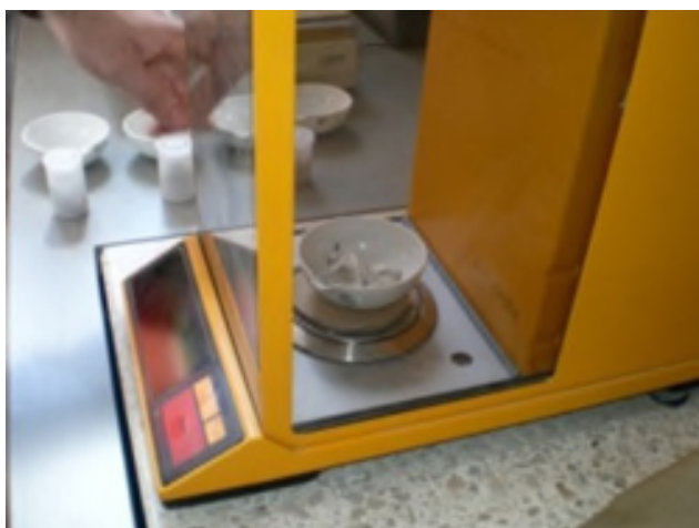
Les échantillons de béton sont broyés et pesés
