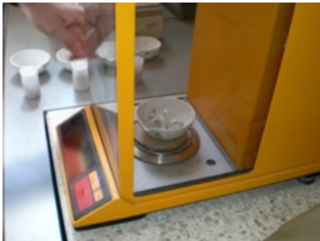
Betonproben werden zerkleinert und gewogen
