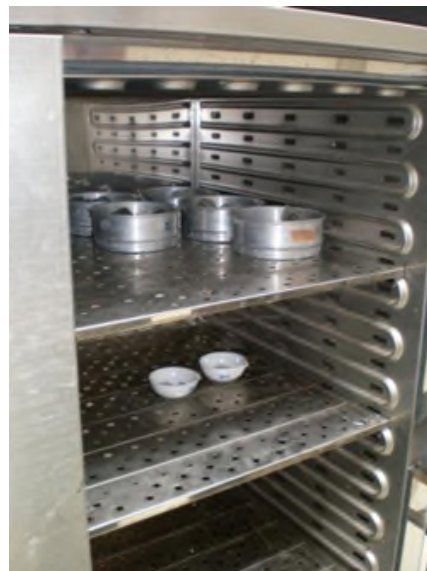
Trocknung der Proben im Klimaschrank
